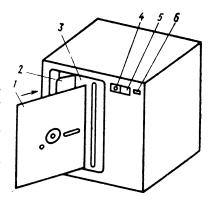
защиты записи на дисках F и R одновременно. При нажатии на эту кнопку устанавливается защита записи, о чем свидетельствует индикация обеих лампочек защиты записи.
