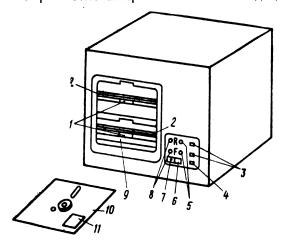
записи означает, что с диска, установленного в данный НГМД, при наличии индикации можно лишь считывать информацию. Рядом
